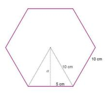
Base de la pirámide: hexágono regular de lado  $10\,\mathrm{cm}$  Dividimos el hexágono en 6 triángulos equiláteros como el de la figura y aplicamos el th. de Pitágoras:  $10^2 = 5^2 + a^2 \implies a^2 = 75 \implies a = \sqrt{75} = 5\sqrt{3}\,\mathrm{cm}$   $A_{triángulo} = \frac{10 \cdot 5\sqrt{3}}{2} = 25\sqrt{3}\,\mathrm{cm}^2$   $A_{hexágono} = 6 \cdot A_{triángulo} = 150\sqrt{3}\,\mathrm{cm}^2$
